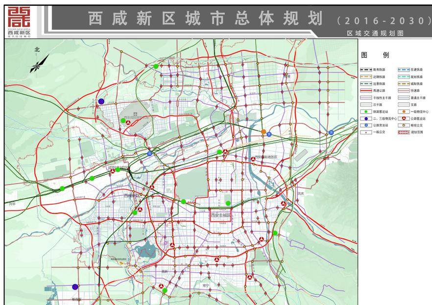
(四) 城市道路系统：采用方格网加环状放射的综合性道路网布局结构，远期道路网密度达到 8.9 公里/平方公里。形成“七横五纵”快速路和“五横六纵”主干路的骨架道路网络格局。
