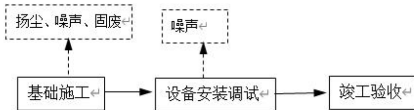
图 4-1 本工程变电站施工流程及环境影响示意图
