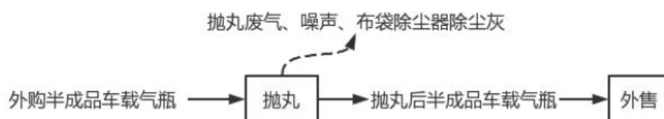
图 2.1-5 半成品车载气瓶抛丸工艺流程及产污环节图
