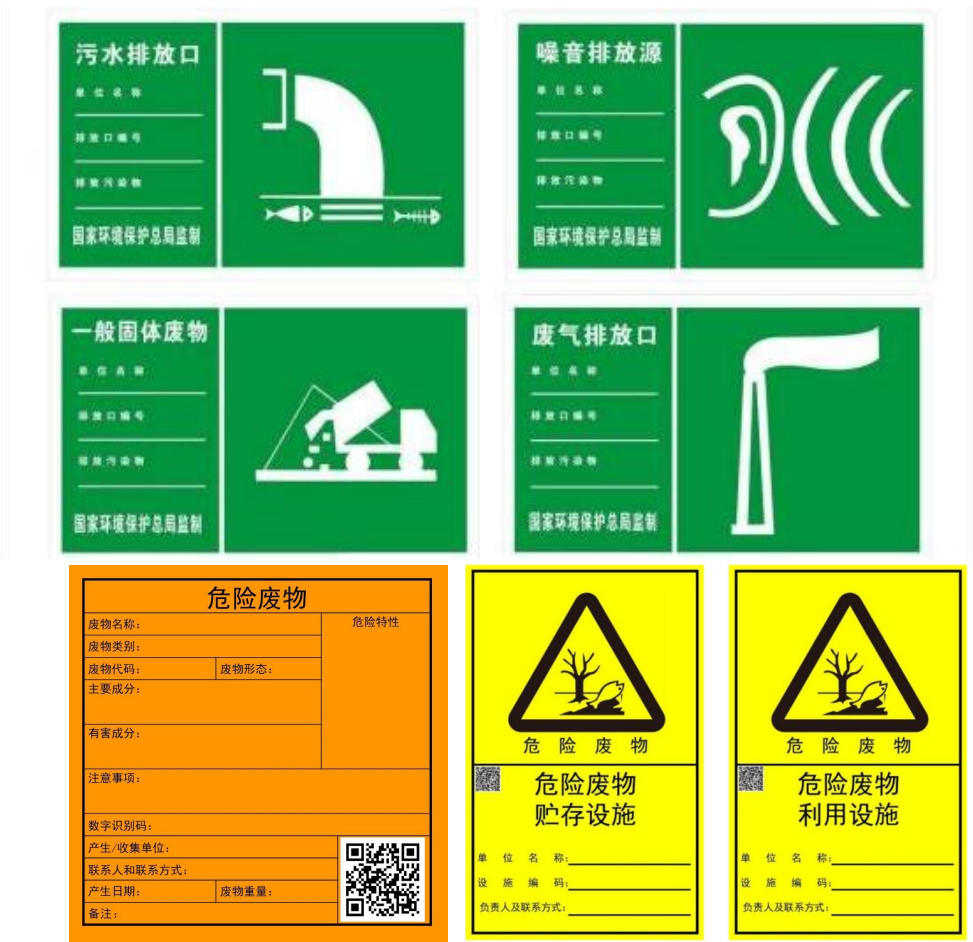
图 8.2-1 污水、噪声、一般固废、废气、危废排放源标志图
