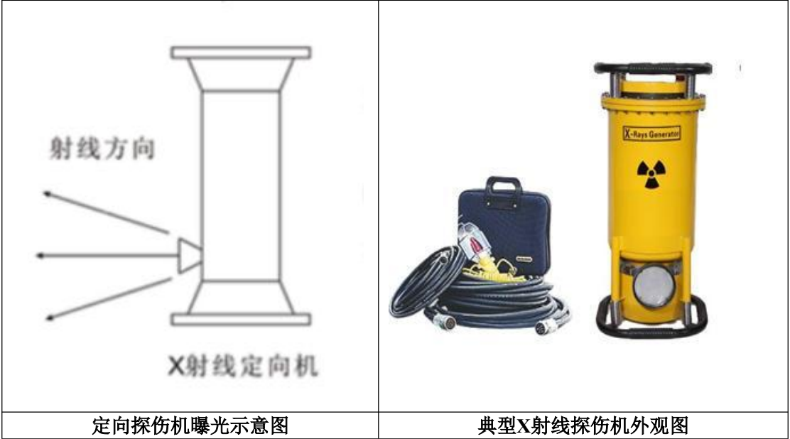
图9-2 本项目X射线探伤机基础构造示意图
