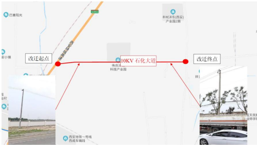
图 1-16 石化大道 10KV 线走径图
