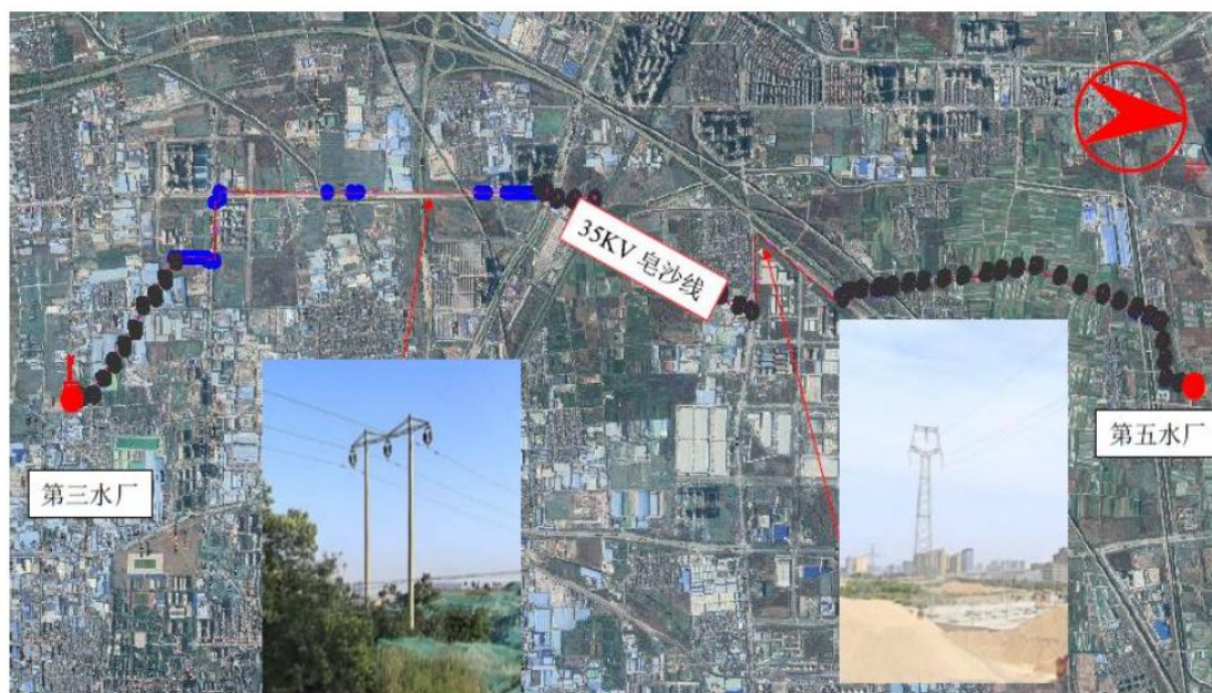
图 1-13 35KV 皂沙线走径图
