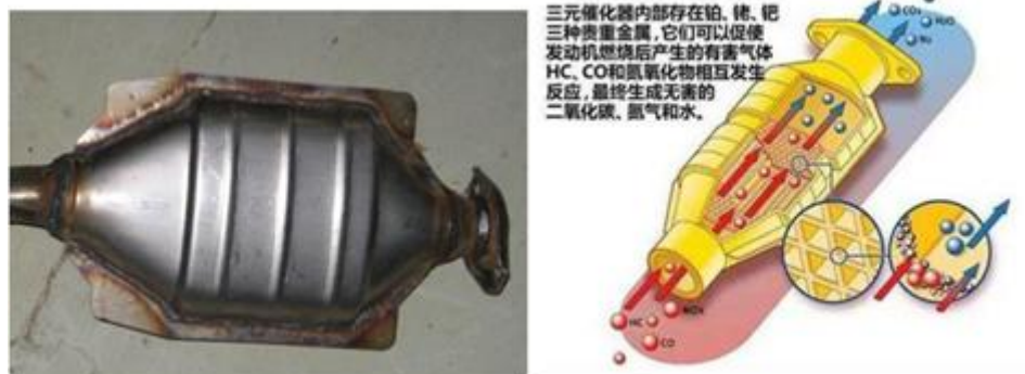
图 2-1 汽车尾气净化催化剂外观及内部结构示意图
