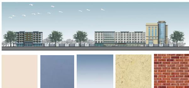
色彩设计由传统灰色向米色过渡，适当点缀色彩较鲜艳的蓝色、红色跳跃色。材质以现代化节能材料为主，同时融入遗址元素，增加钢材和米色贴面等材质。局部可采用垂直绿化进行遮挡美化。
