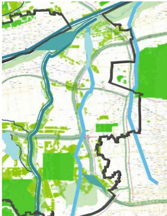
将太平河**规划定位为小型雨水行泄通道**，接纳**两侧雨水分区范围内的雨水排放**。
