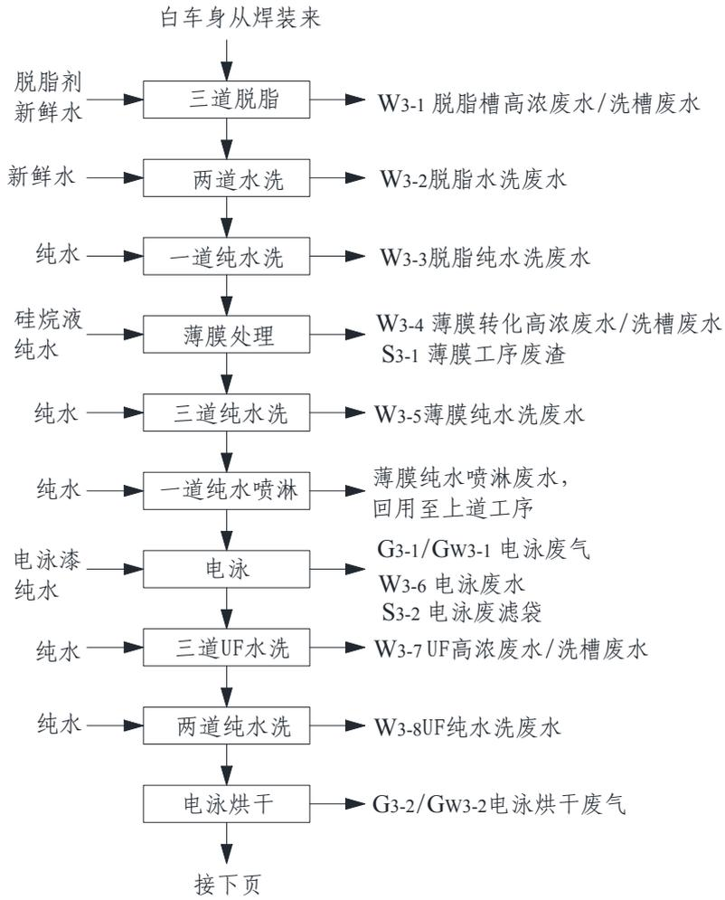
图 3.2.3-1 涂装车间生产工艺流程及产污节点图 (1)
