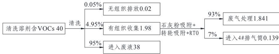
图 3.2.5-10 主线水性漆喷枪清洗 VOCs 平衡图
