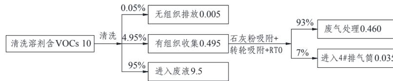
图 3.2.5-13 双色油性漆喷枪清洗 VOCs 平衡图
