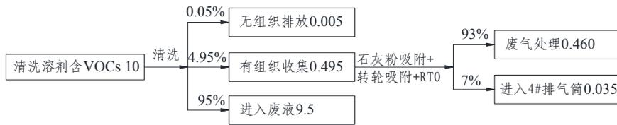
图 3.2.5-12 双色水性漆喷枪清洗 VOCs 平衡图
