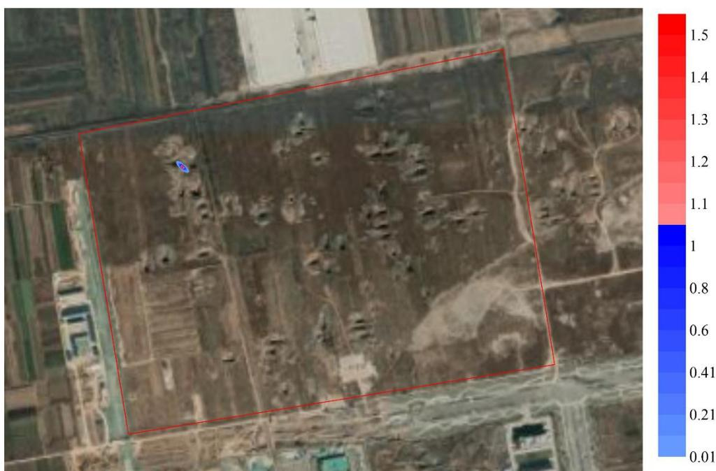
图 5.2.4-14 薄膜水池发生非正常泄露 1000d 后氟化物浓度分布图
