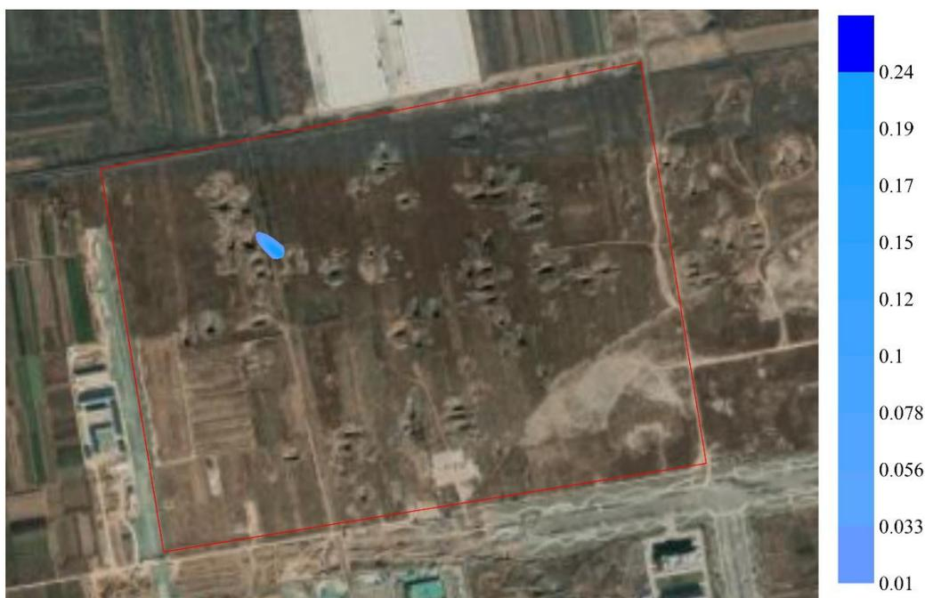
图 5.2.4-15 薄膜水池发生非正常泄露 10000d 后氟化物浓度分布图
