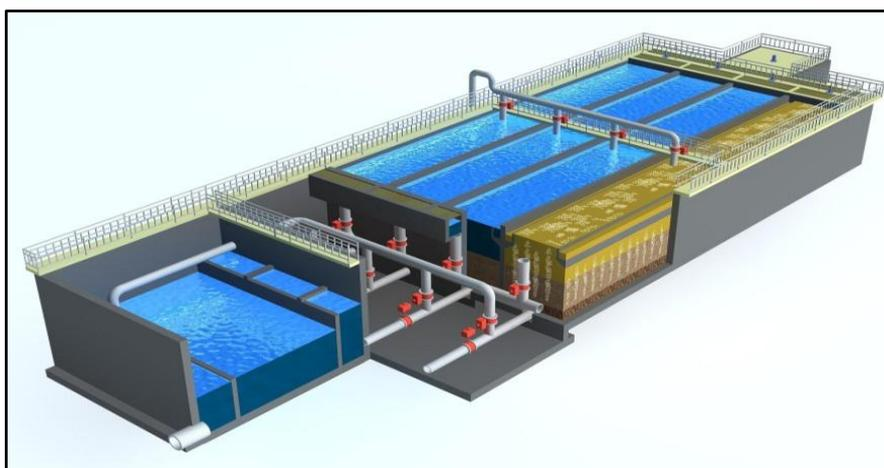
图 6 反硝化深床滤池结构
