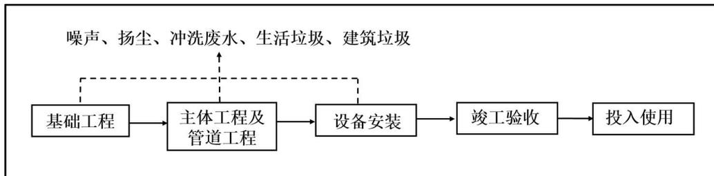
图 4 本项目施工期工艺流程及产污环节图
