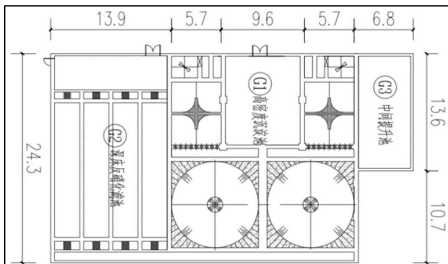
图 7 中间提升、高密度沉淀、深床反硝化滤池连体池
