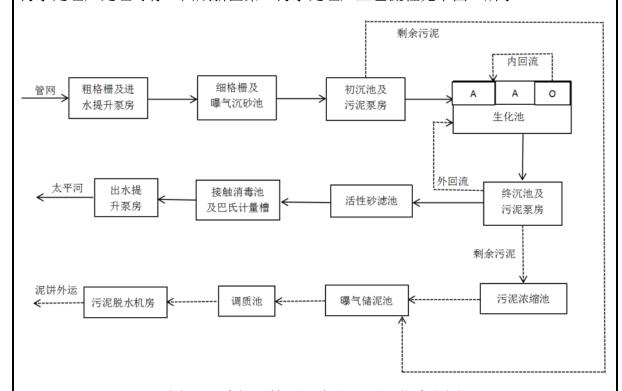
图 4 西咸新区第一污水处理厂工艺流程图
