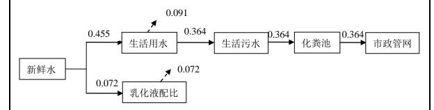
图 1 项目水平衡图 单位: t/d
