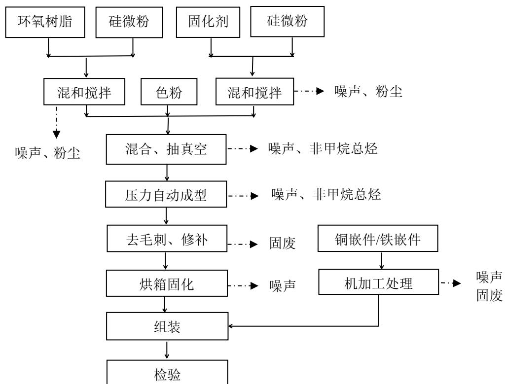
图 2 项目工艺流程与产污环节图
