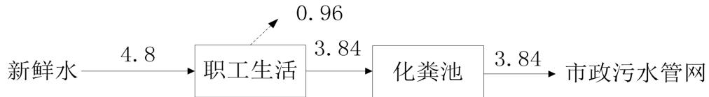
图 1 项目用、排水平衡图 ( $\text{m}^3/\text{d}$ )
