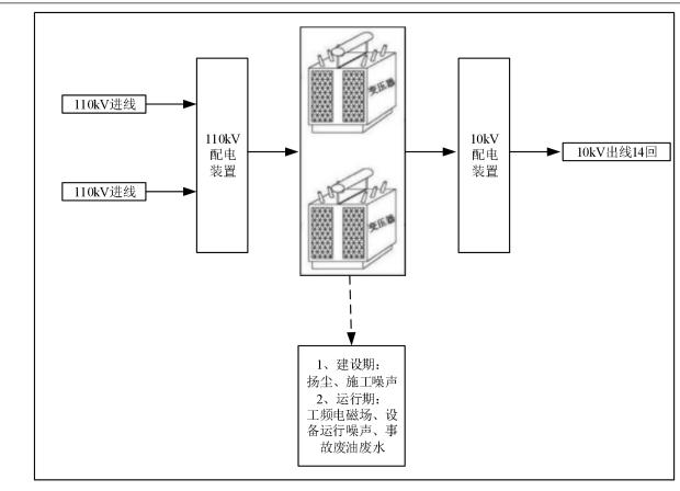
图 4-3 110kV 变电站工艺流程及环境影响示意图
