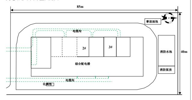
图 4-2 兴咸 110kV 变电站总平面布置图
