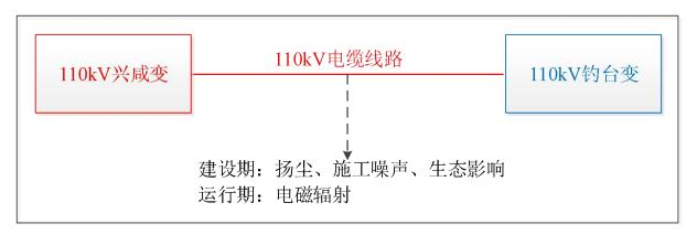
图 4-4 输电线路工艺流程及产污环节示意图
