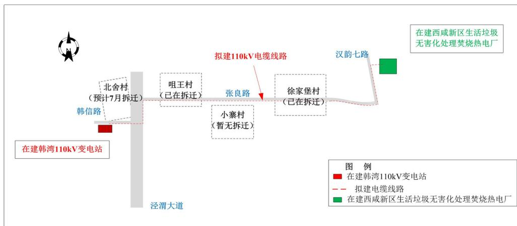
图 1-4 工程线路路径示意图
