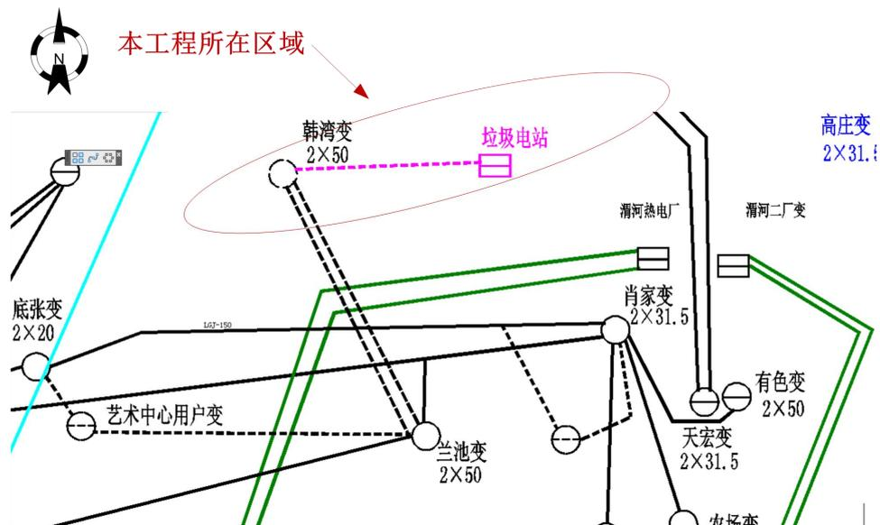
图 1-1 工程系统本期接入方案示意图
