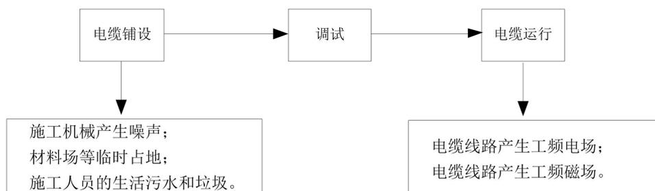
图 5-2 本工程 110kV 电缆输电线路工程环境影响示意图
