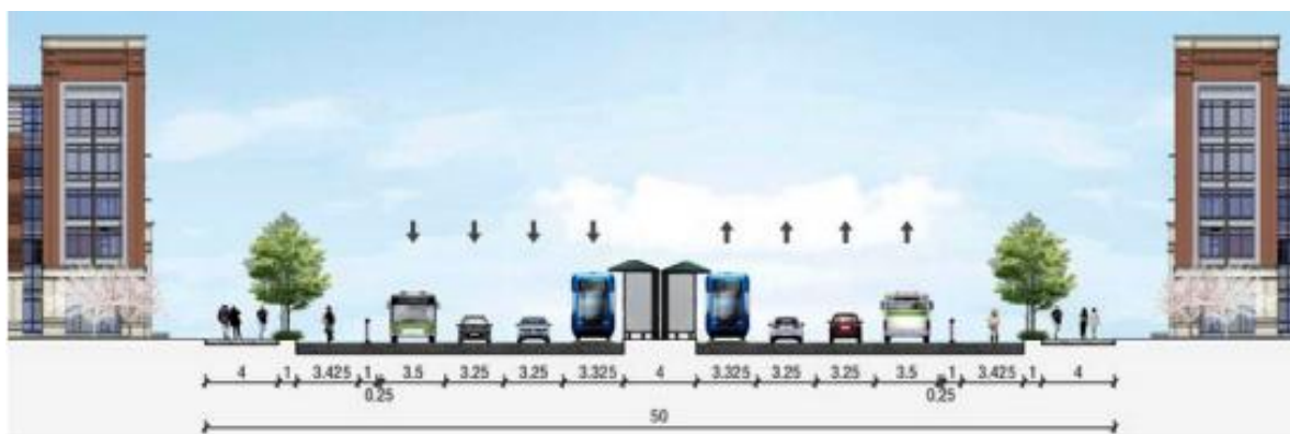
图 3.1.6-3 豫章大道结合智轨敷设现状断面示意图（车站）
