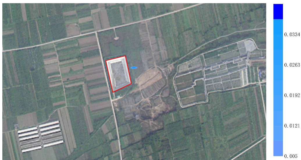
图 7.3-3 调节池发生非正常泄露 3650d 后氨氮浓度分布图
