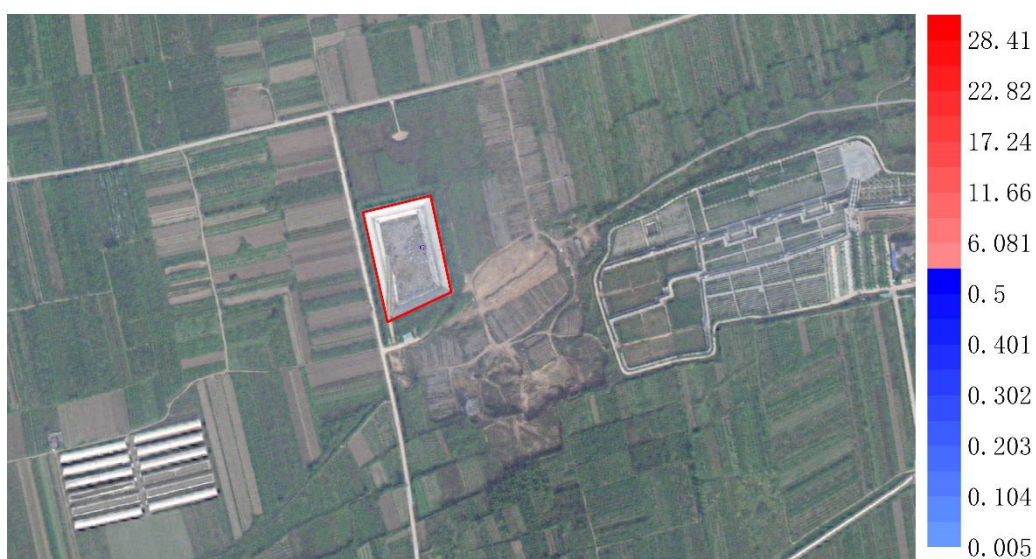
图 7.3-4 库区发生非正常泄露 100d 后氨氮浓度分布图
