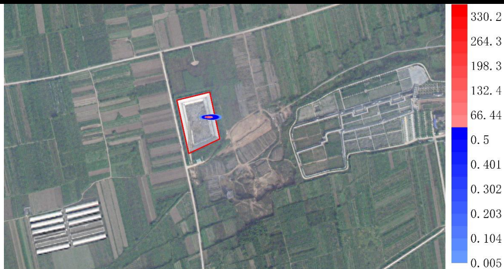
图 7.3-6 库区发生非正常泄露 3650d 后氨氮浓度分布图
