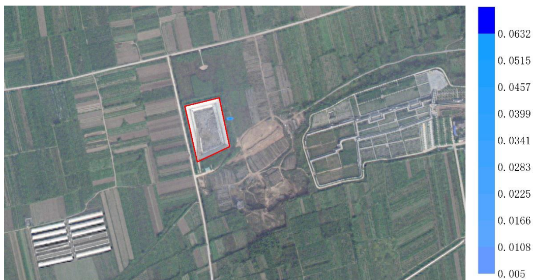
图 7.3-2 调节池发生非正常泄露 1000d 后氨氮浓度分布图
