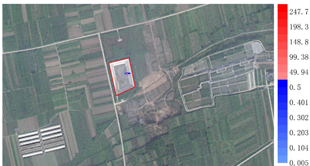
图 7.3-5 库区发生非正常泄露 1000d 后氨氮浓度分布图
