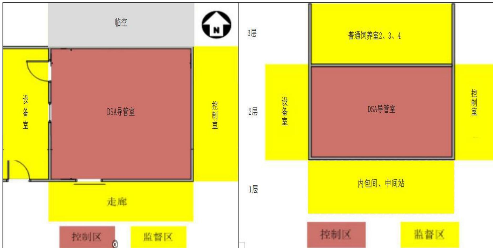
图1-5 DSA机房平面及立面布局图
