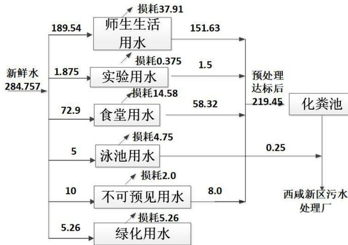
图 2-3 项目水平衡图 (单位: m<sup>3</sup>/d)
