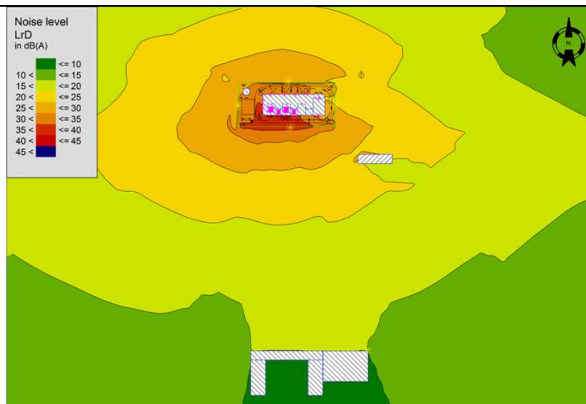
图 4-3 富裕 110kV 变电站等效噪声级预测图
