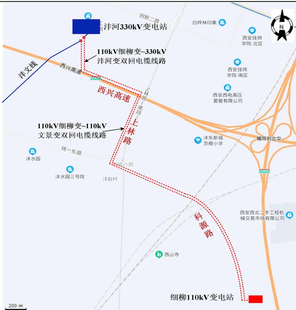
图 2-5 本项目新敷设线路路径示意图
