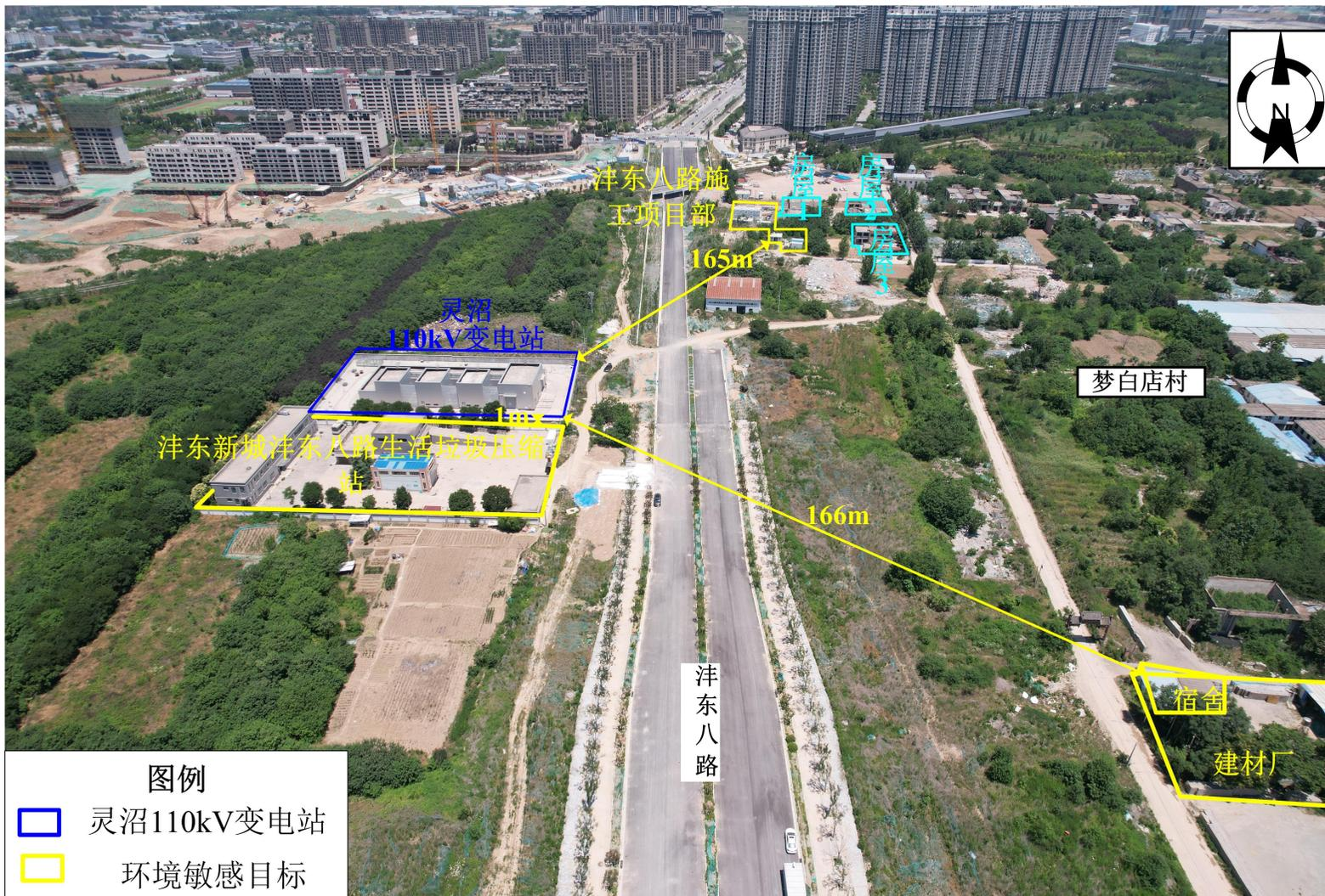
图 3-14 间隔扩建灵沼 110kV 变电站电磁环境敏感目标、声环境保护目标分布航拍示意图 (2)
