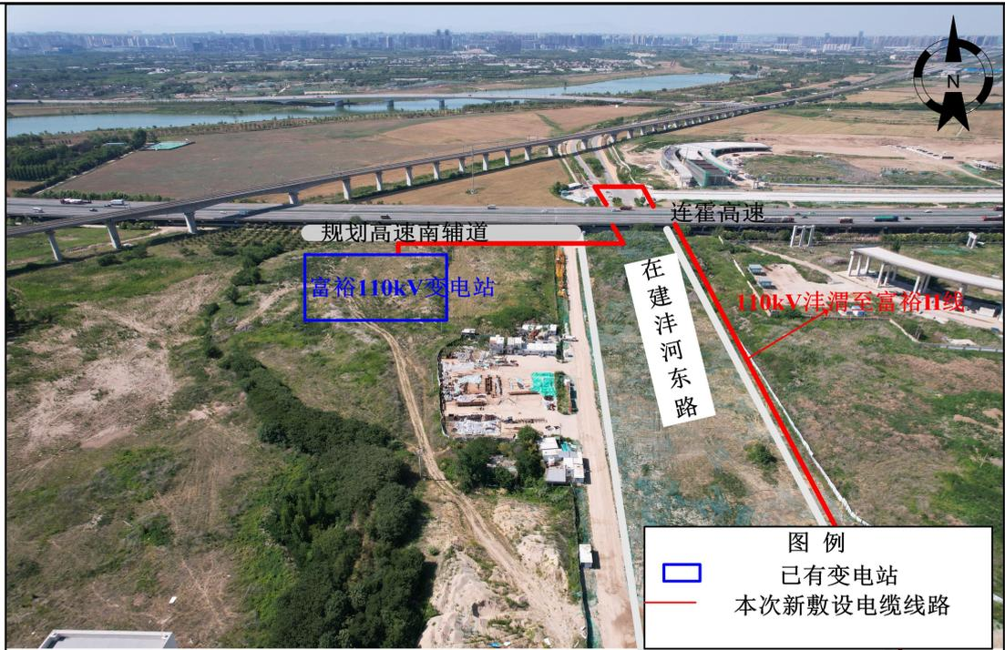
图 2-8 沔渭~富裕 110kV VII 回线路工程路径航拍示意图
