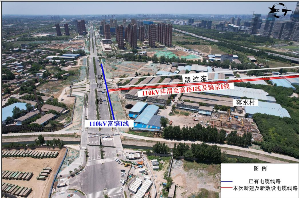
图 2-6 富裕~镐京 I 线 $\pi$ 接入沔渭变 110kV 线路工程路径航拍示意图
