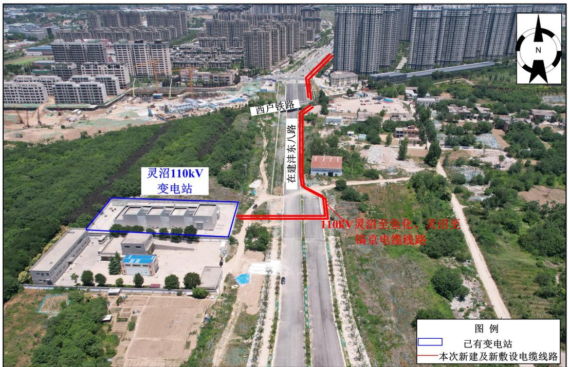
图 2-14 鱼化~镐京 I 线π接入灵沼变 110kV 线路工程路径航拍示意图
