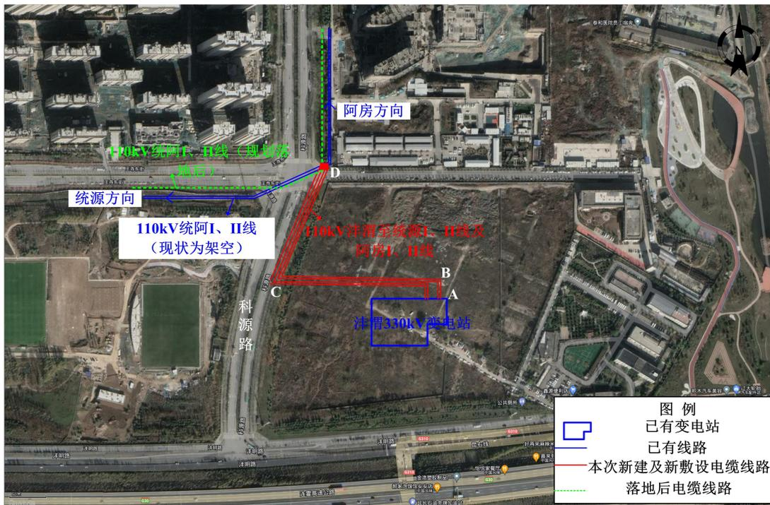
图 2-2 统源~阿房线路双 $\pi$ 接入沣渭变 110kV 线路工程路径示意图
