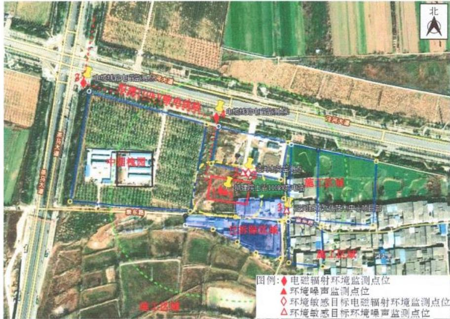
图 3-1 拟建院士谷 110kV 变电站及周边监测点位示意图
