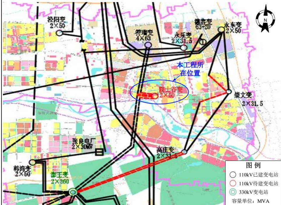
图 1-1 本期本项目所在区域电网规划接线图
