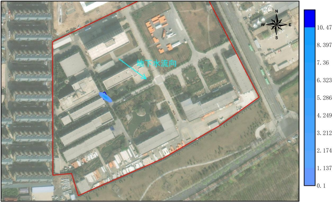
图 6.3-1 环氧丙烷储罐区发生非正常泄露 100d 后浓度分布图
