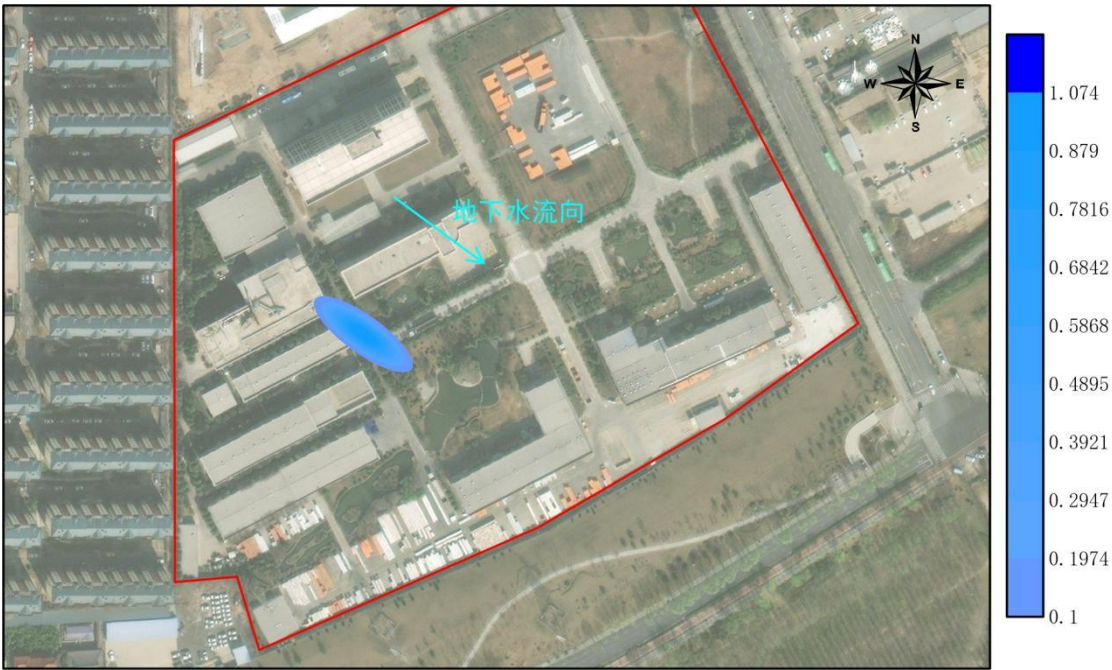
图 6.3-2 环氧丙烷储罐区发生非正常泄露 1000d 后浓度分布图
