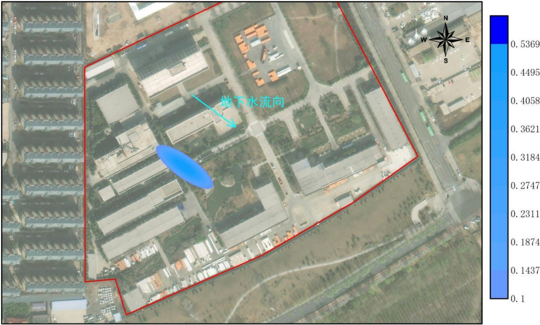
图 6.3-3 环氧丙烷储罐区发生非正常泄露 2000d 后浓度分布图
