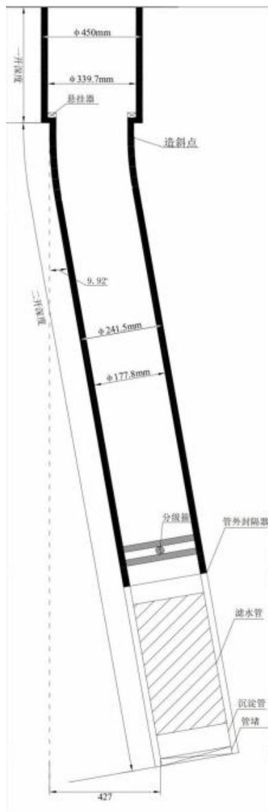
图2-5 回灌井（定向井）井身结构设计示意图
