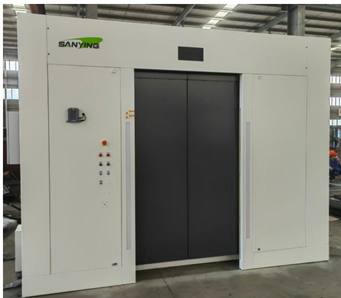
图 9-5 高能 X 射线断层扫描仪（Multiscale Voxel 1000）屏蔽体外形图
